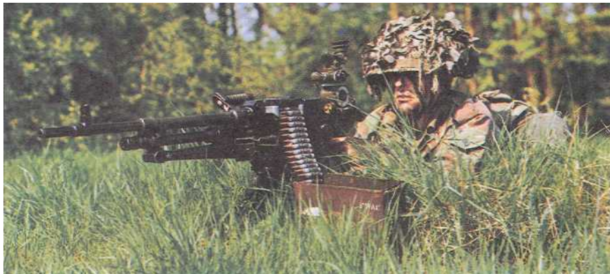
Сверху и снизу: GPMG установлен на станке для огневой поддержки таким образом, что при стрельбе на дальность до 600 м линия огня будет не выше 60 см от земли.
