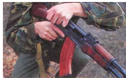
Заряжая оружие, отведете затворную рукоятку назад и отпустите ее.
