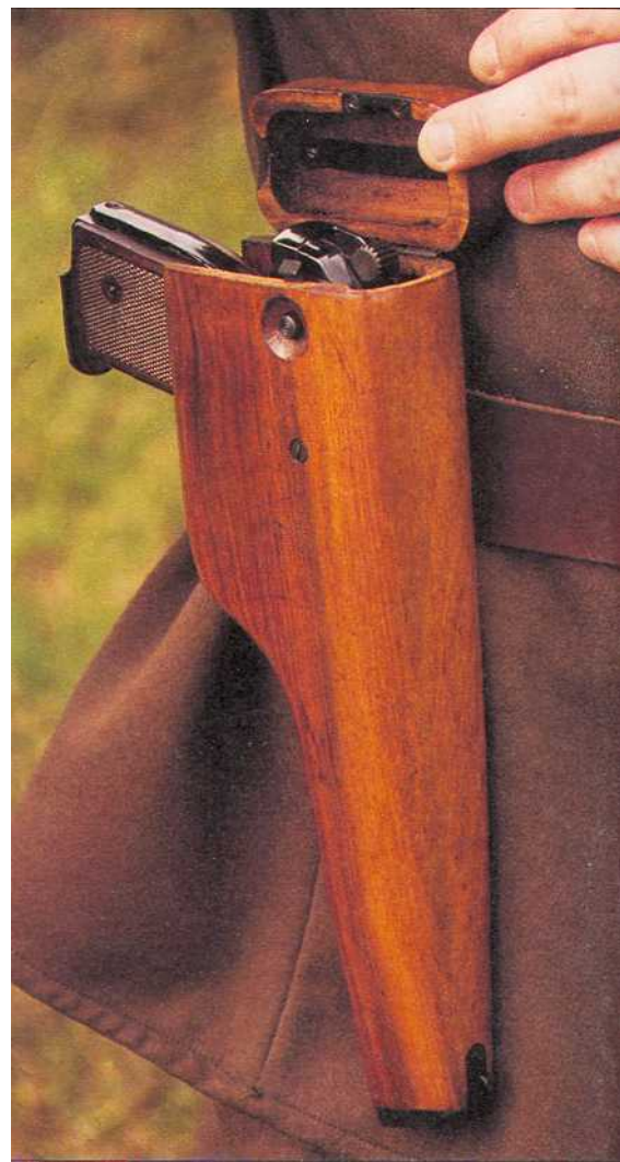
«Стечкин» трудно быстро достать из массивной деревянной кобуры, которая также предназначена для использования в качестве приклада.
