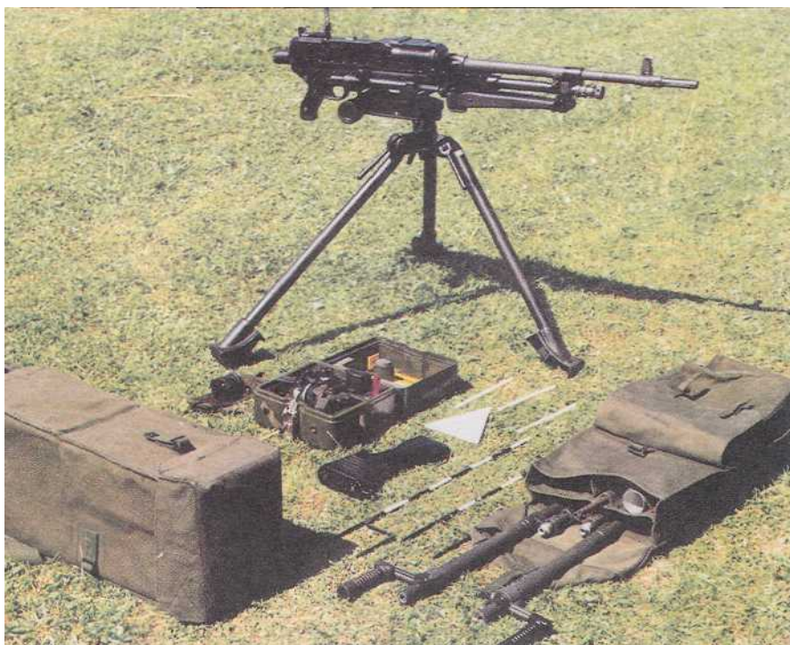
Сверху и снизу: GPMG установлен на станке для огневой поддержки таким образом, что при стрельбе на дальность до 600 м линия огня будет не выше 60 см от земли.
