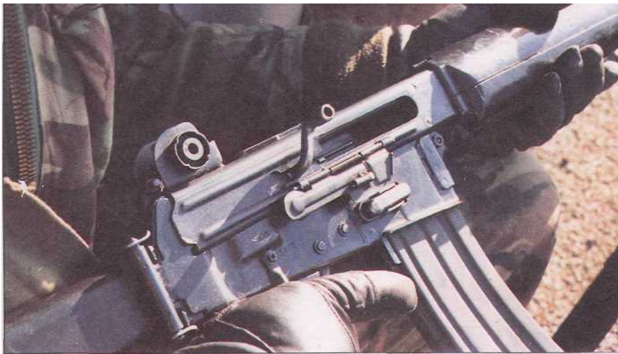
Когда последний патрон отстрелян, затвор остается в открытом положении, как показано на рисунке. После замены магазина потяните рукоятку затвора назад, чтобы освободить затвор, тогда он пойдет вперед и дошлет патрон в патронник.
