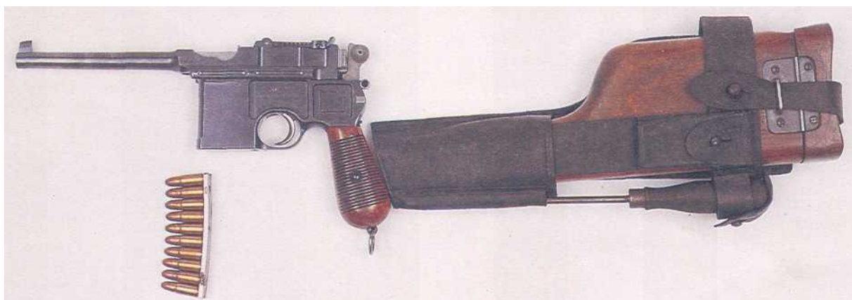
«Маузер» предназначался для применения как пистолет и как самозарядный легкий карабин. Деревянная кобура-приклад похожа на ту, что в 50-х годах была сделана для советского пистолета Стечкина. Неотъемлемый магазин «маузера» на 10 патронов снаряжался при помощи специальной обоймы. Деления на прицеле оптимистично установили на 1000 м.
