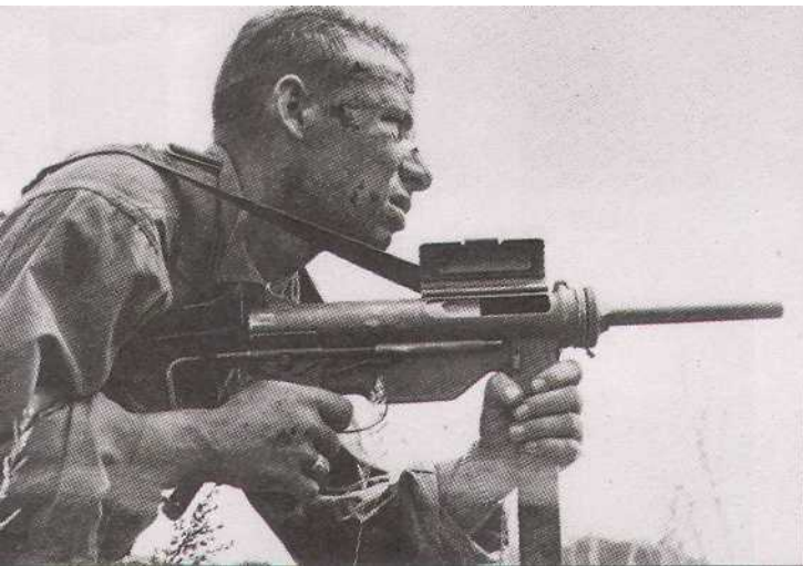
Американский рейнджер с М-3А-1 в патруле. Рукоятка затвора постоянно ломалась, поэтому в модели А-1 взвод затвора производится через окно выбрасывателя при помощи пальца.
