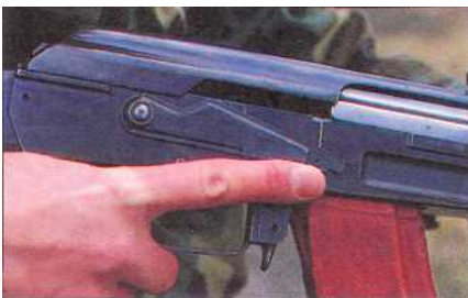
Переводчик имеет три положения: предохранитель, автоматическая стрельба или одиночные выстрелы. При перемещении он издает громкий щелчок, им трудно пользоваться в толстых рукавицах.
