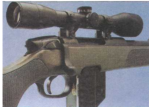
На снимке показано преимущество, которое дает 10-зарядный коробчатый магазин с прозрачной задней стенкой. Обратите внимание на то, что предохранитель находится в переднем положении и выключен. На это указывает красная точка. Кроме того, из затвора сзади выходит шилька, показывая, что оружие стоит на взводе.
