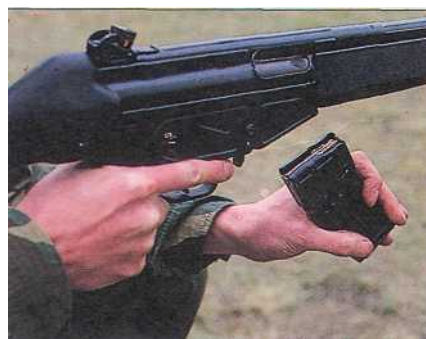
Вверху и внизу: К винтовке НК-33 присоединяется 25-зарядный магазин. Магазин отличается от того, что применяется в американской М-16 и британской SA-80. В G-41 вы получаете дополнительно пять патронов.
